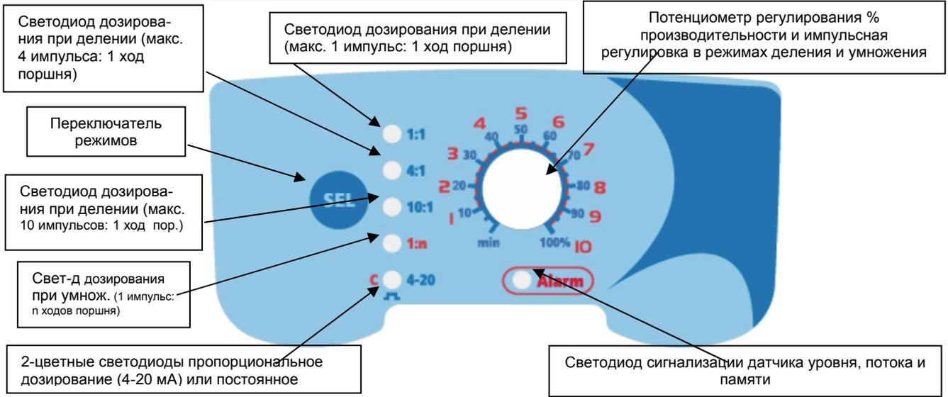
Регулирование можно осуществлять с помощью ручек регулировки на лицевой панели насоса.
