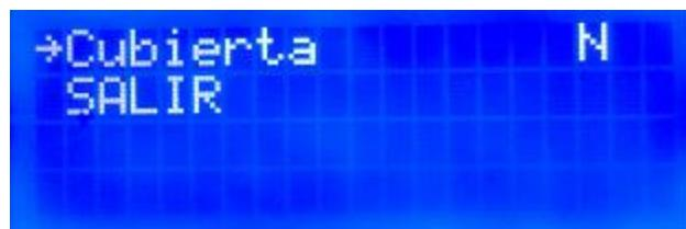
Nach der Aktivierung des Systems zur Abdeckungserkennung muss der eingebaute Endlagensor ausgewählt werden, entweder normalerweise geöffnet (n.o.) oder normalerweise geschlossen (n.c.).
