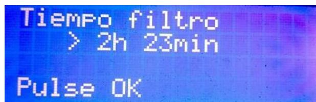
Si al final del día, la bomba de filtración permanece menos horas en funcionamiento del que estipula el equipo para que haya un nivel de cloro óptimo en el agua, el equipo mostrará un mensaje de advertencia.
