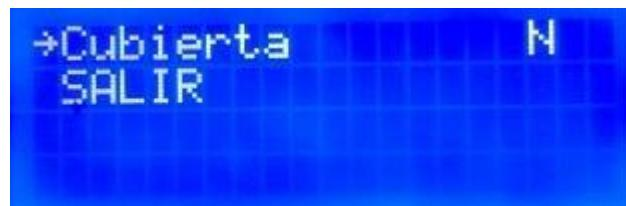
Когда активируется датчик обнаружения накрытия, система спросит, какой тип датчика вы установили: нормально открытый (N.O.) или нормально закрытый (N.C.)
