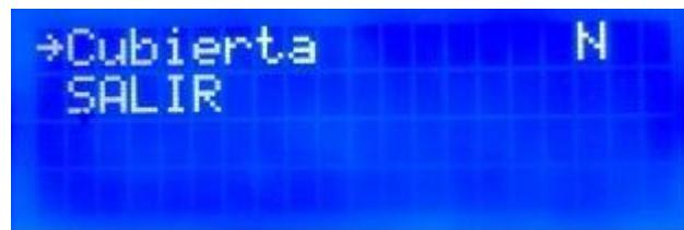
Una vez activado el sistema de detección de cubierta, se le requerirá seleccionar el tipo de sensor de final de carrera que tenga instalado, ya sea normalmente abierto (n.o.) o normalmente cerrado (n.c.).
