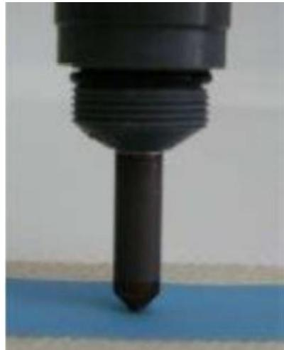
4) Осторожно промойте наконечник водопроводной водой и снова заполните ее новыми электролитами. В случае, если наконечник должен быть заменен, установите новый.
