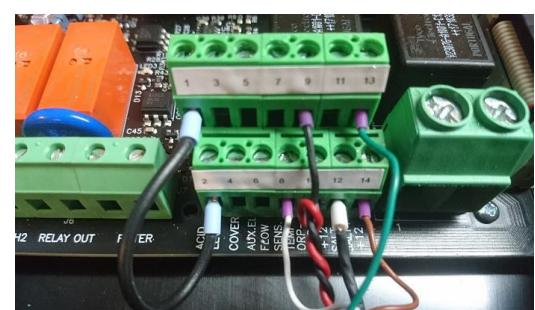
**Schwarzes Kabel** (GND): Anschluss #12 der Steckerleiste
