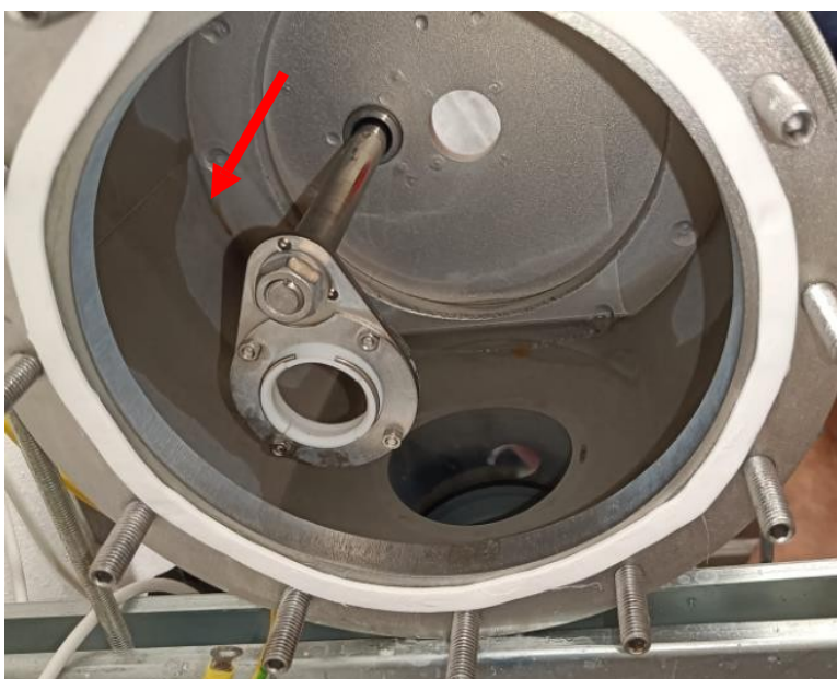
Рис. 37: Напрямок висування очисного стрижня (зображення наведено лише для ілюстрації).
